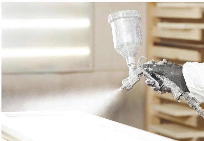
*Pour les applications au pulvérisateur, utilisez un pistolet à peinture à basse pression muni d'une petite buse.*
